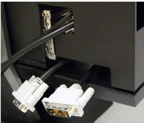
Dongle durch die neue Öffnung verlegen
