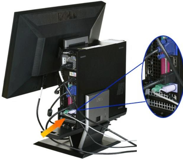
**8. Verlegen Sie die Kabel durch die Öffnungen der Kabelabdeckung.**
